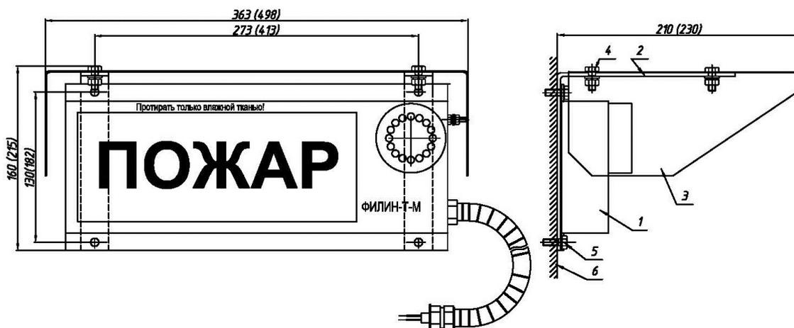
**Рисунок 2** – Монтаж табло Филин-Т-М или Филин-Т-Б (все модели) с козырьком светозащитным модели КС 908.3139
